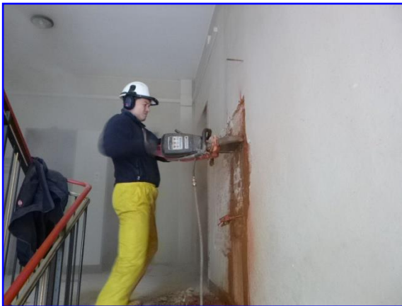
Foto 24: Esecuzione del taglio orizzontale per l'inserimento del martinetto
