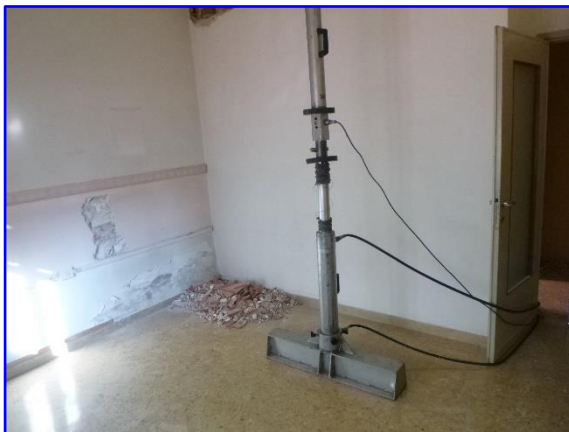
Foto 35: Martinetto oleodinamico per l'applicazione del carico sul solaio
