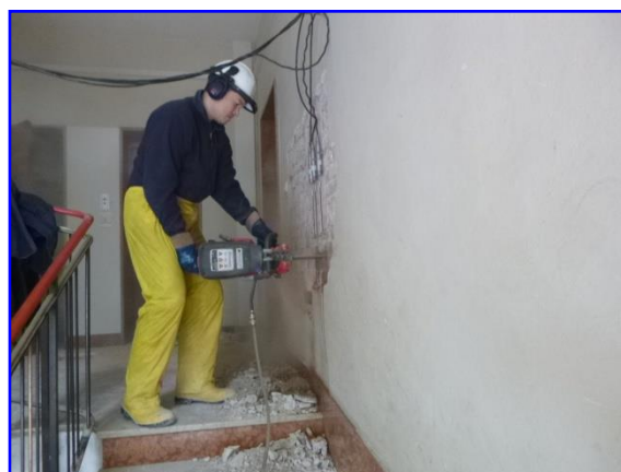
Foto 23: Esecuzione del taglio orizzontale per l'inserimento del martinetto
