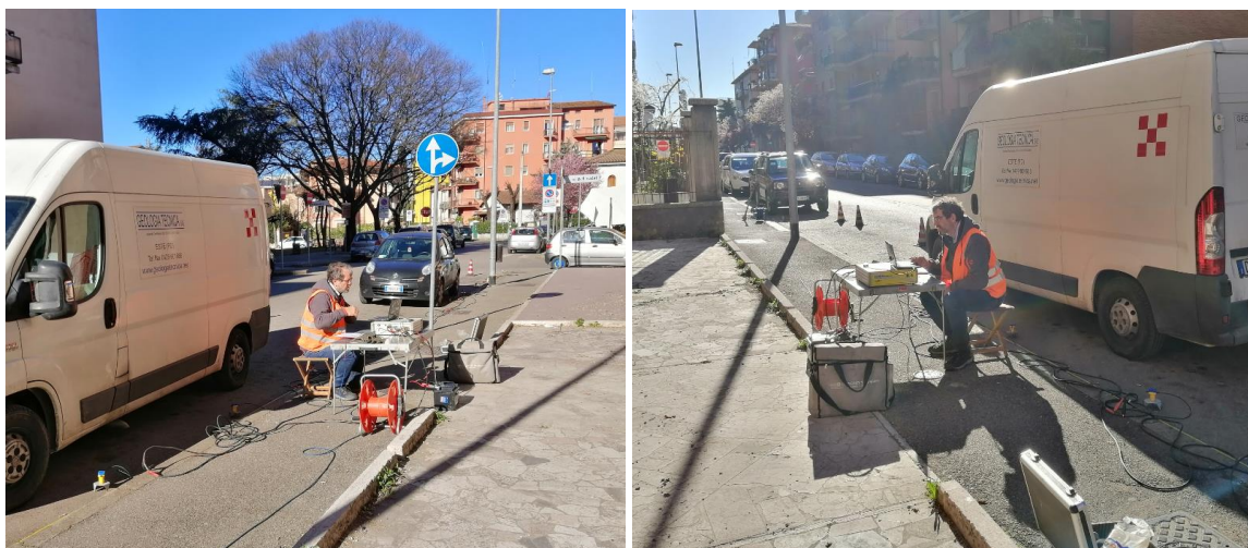
Foto esecuzione indagine Masw
