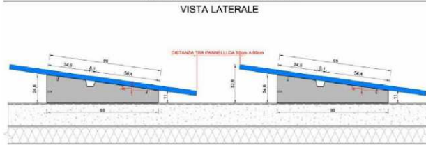
DIMENSIONI ZAVORRA E ALTEZZA PANNELLO DA TERRA - UNITA' DI MISURA cm POSA PANNELLO VERTICALE
